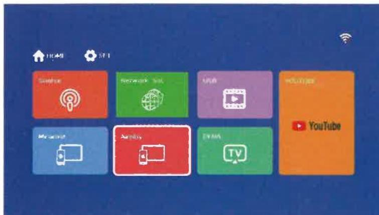
2. Método 1: Conecte el teléfono y el proyector al mismo WIFI. Abra la función "Screen mirroring" del dispositivo iOS, en este momento, el dispositivo iOS mostrará el nombre del dispositivo de proyección, haga clic en el nombre para realizar la co-pantalla inalámbrica del dispositivo iOS y el dispositivo de proyección. Haga clic en el nombre para realizar la co-pantalla inalámbrica del dispositivo iOS y el dispositivo de proyección.
